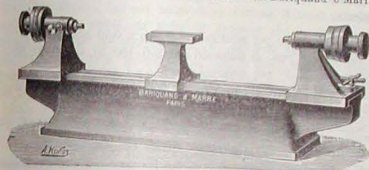
Fig. 10. — Piccolo banco micrometrico Bariquand e Marre.
