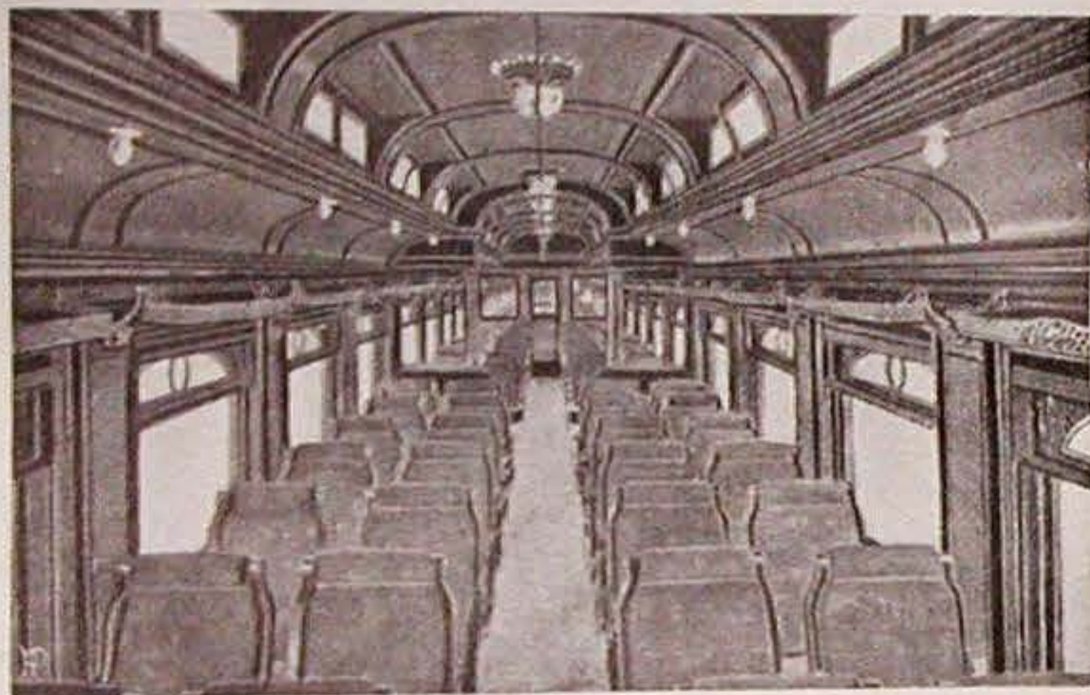
Fig. 39. — Vagone a corridoio centrale con posti isolati.
