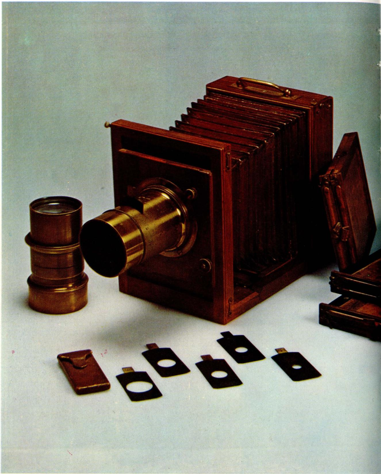
*Tipica camera da viaggio del secolo scorso: legni pregiati, due ottiche con schema Petzval di diversa focale, chassis di legno doppi, diaframmi ad inserzione tipo Waterhouse. Il soffietto è di pelle rossa. Il dorso è rotante, per le inquadrature orizzontali. La plancia portaottica decentrabile.*
