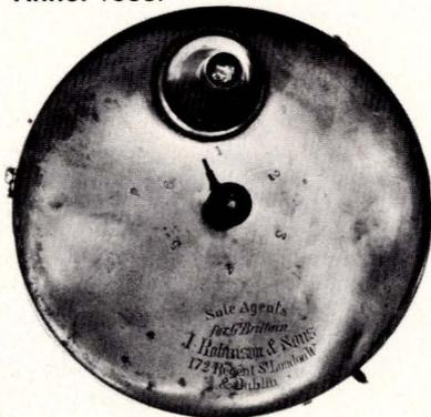
**Formato:** 6 esposizioni di circa 4 cm di diametro su lastra circolare di circa 14 cm di diametro (il disco viene anche fornito in forma ottagonale).
