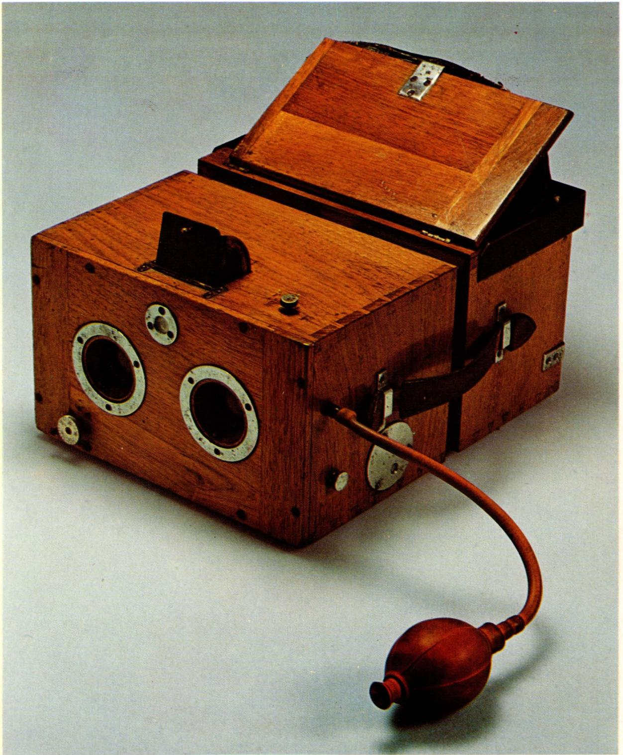
*Camera detective stereoscopica con magazzino a scamotaggio. Epoca: fine del secolo scorso.*
