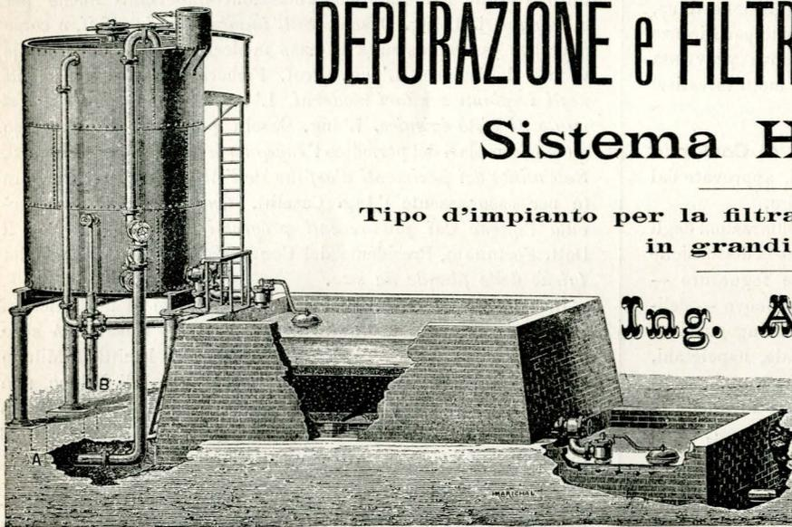
Tipo d'impianto per la filtrazione delle acque potabili in grandi masse.
