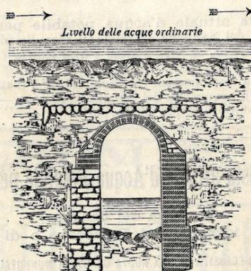
FIG. 1. — Sezione trasversale della galleria sotto il torrente Sangone.
