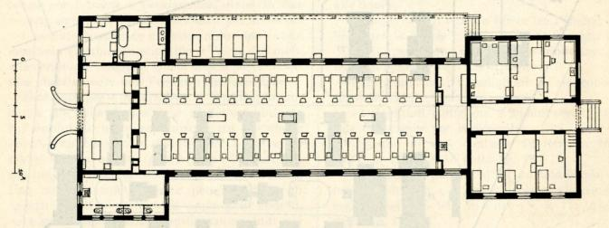
Fig. 19. — Pianta di un grande padiglione ad un solo piano.
