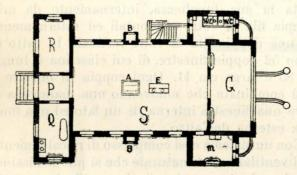
Fig. 13. — Pianta d'un padiglione d'isolamento per 15 letti.
