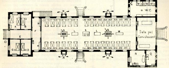
Fig. 12. — Pianta di un grande padiglione per 33 letti (Scala di 1:250).
