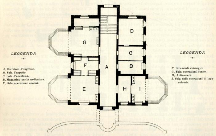
Fig. 17. - Pianta dell'edificio per le operazioni chirurgiche.
