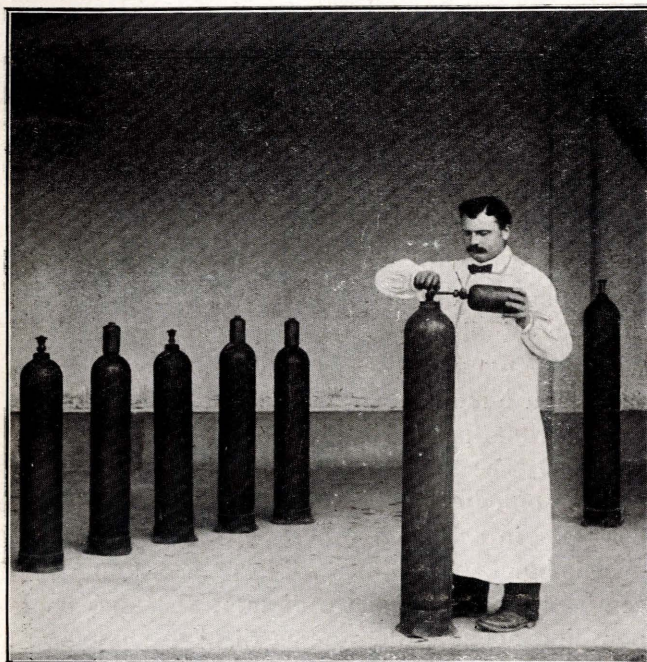
Fig. 6. - Carica delle bombette col CO 2 . (Fot. Gioia).
