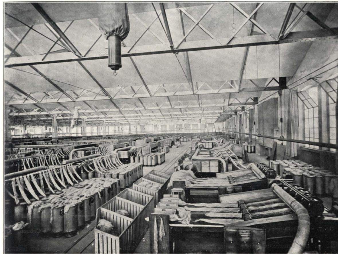
Fig. 6. - Impianto di aspirazione delle polveri degli stiratoi (étaleuses) del Linificio e Canapificio Nazionale a Lodi.
