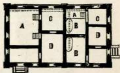
Fig. 124. Badehaus der Zeche König in Oberschlesien. A Bassin. B Bad. C Douche. D Auskleidezimmer.
