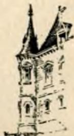
servant ordinairement d'escalier et offrant aussi à l'intérieur de petits réduits plus ou moins richement décorés. Quelquefois elles prennent naissance au niveau du sol, quelquefois aussi ces tourelles, de forme circulaire ou polygonale, sont placées en encorbellement, en saillie sur le vide et se terminent en cul-de-lampe.
