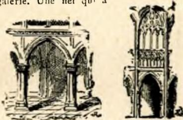
huit travées. — Se dit aussi dans l'architecture classique de l'intervalle compris entre deux pilastres. La décoration d'une travée.
