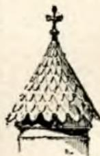
désagréables à l'œil et, de plus, d'une grande fragilité. Les architectes du moyen âge se servaient, pour la toiture de ces tourelles, soit d'ardoises en écaïlles ordinaires, soit même d'ardoises en écaïlles *biaises*, et au xiii<sup>e</sup> et au xiiii<sup>e</sup> siècle, ces ardoises mesuraient parfois
