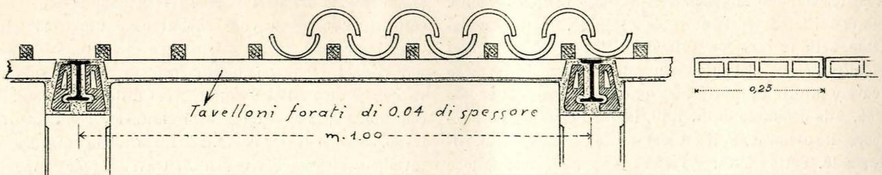
Fig. 71. — Struttura incombustibile per tetti — 1:10.
