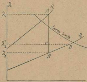
Fig. 3. — Determinazione, mediante il diagramma del Mollier, del lavoro disponibile di 1 kg. di vapore.
