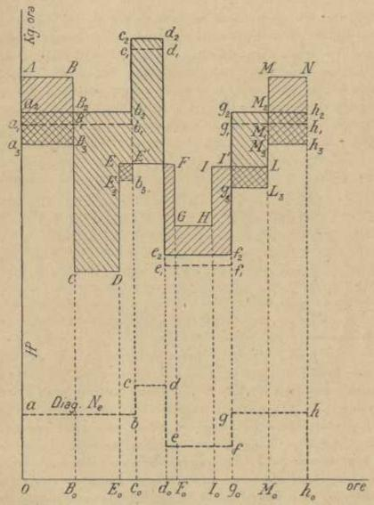
Fig. 8. — Diagrammi annuali di consumi di vapore — Il diagramma  $0a_1b_1c_1d_1e_1f_1g_1$   $h_1h_0$  di consumo di vapore per forza motrice è intrecciato con quello 0ABCDEF GHILMN $h_0$  di consumo di vapore per riscaldamento — Aree tratteggiate con linee discendenti verso sinistra == pesi di vapore da prelevarsi direttamente; quelle con linee discendenti verso destra == pesi di vapore non utilizzati per riscaldamento.
