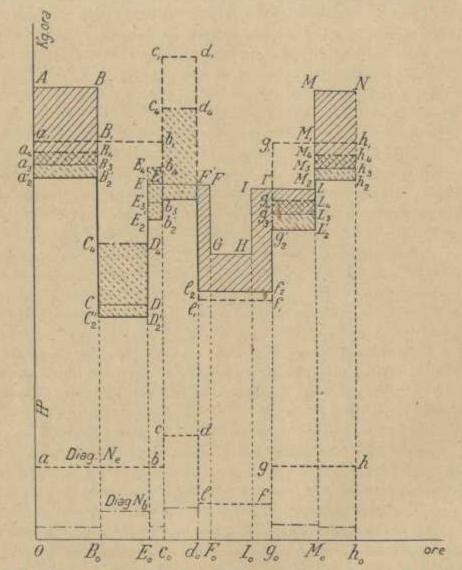
Fig. 9. — Diagrammi annuali di consumi di vapore e di forza motrice nel caso del ricupero parziale — Aree tratteggiate con linee continue == pesi di vapore (saturo e secco) da prelevarsi direttamente — Aree tratteggiate con linee discontinue == pesi di vapore che agiscono nella motrice e vanno al condensatore.
