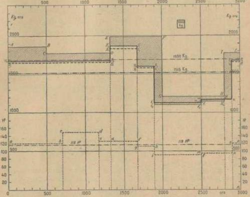
Fig. 11. — Studio d'impianto a ricupero — Soluzione I — Motrice di 90 HP e motrice elettrica svolgente nell'intera annata di lavoro circa 15400 HP-ora — Area trateggiata == peso di vapore (saturo e secco) prelevato direttamente dalle caldaie.
