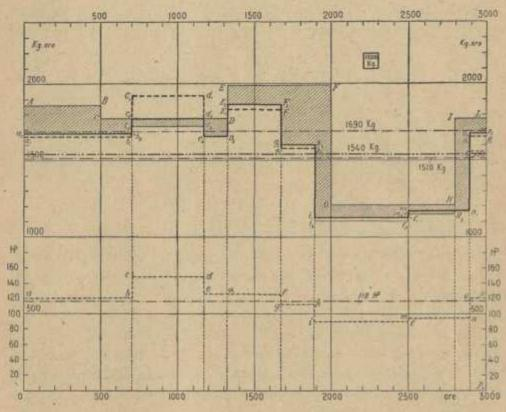
Fig. 13. — Studio d'impianto a ricupero — Soluzione II — Motrice composta di due cilindri, aventi rendimento massimo rispettivamente alle potenze di 90 HP e di 60 HP — Area tratteggiata == peso di vapore di prelevamento diretto.
