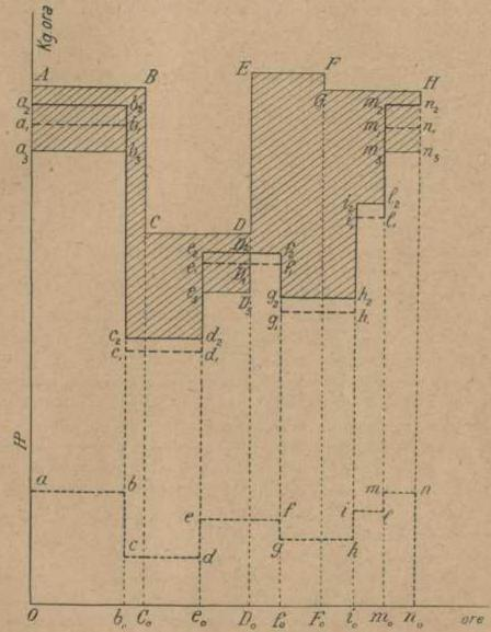
Fig. 5. — Trasformazione del diagramma annuale di consumo di laroro motore  $(Oabcdefghilmnn_0)$  in quello corrispondente di consumo di vapore  $(Oa_1b_1c_1d_1e_1f_1g_1h_1l_1m_1n_1n_0)$ . Quest'ultimo rimane tutto al disotto del diagramma di consumo di vapore per riscaldamento  $(oA\ B\ C\ D\ E\ F\ G\ Hn_0)$  — Area tratteggiata = peso di vapore (saturo e secco) da prelevarsi direttamente dalle caldaie.
