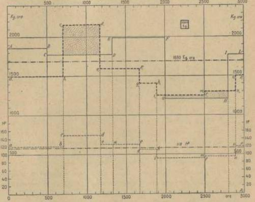
Fig. 10. — Studio d'impianto a ricupero — Prima trasformazione del diagramma di consumo di lavoro motore nel corrispondente diagramma di consumo di vapore — Area trat teggiata == peso approssimativo di vapore, che non trova immediata utilizzazione.
