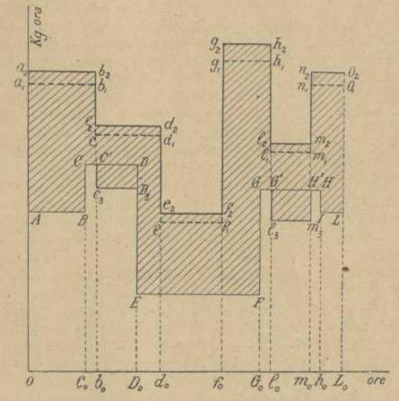
Fig, 7. — Diagrammi annuali di consumi di vapore — Il diagramma  $Oa_1b_1c_1d_1e_1$   $f_1$   $g_1$   $h_1$   $l_1$   $m_1$   $n_1$   $o_1$   $L_o$  di consumo di vapore per forza motrice rimane tutto al disopra di quello  $OABCDEFGHILL_O$  di consumo di vapore per riscaldamento — Area tratteggiata = peso di vapore (saturo e secco) che dovrà sfuggire nell'atmosfera.
