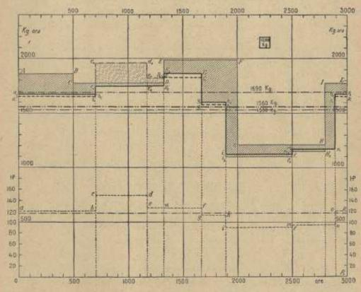
Fig. 14. — Studio d'impianto a ricupero — Soluzione III — Motrice a ricupero parziale — Aree tratteggiate con linee continue—pesi di vapore di prelevamento diretto — Aree tratteggiate con linee discontinue—peso di vapore che va al condensatore.
