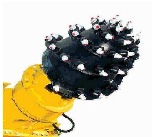
Figura 4. Testa fresante: diametro: 1.3 m, lunghezza: 1.6 m, numero di utensili (a matita): 58
