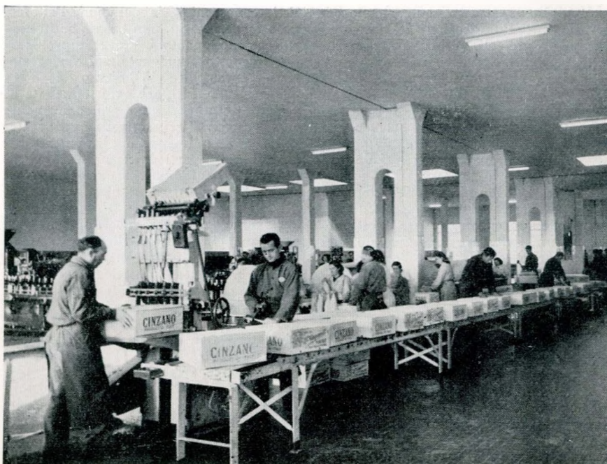
Fig. 17 - Movimento casse e chiodatura automatica.
