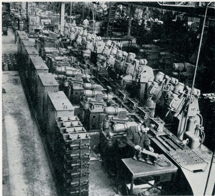
Fig. 12 - Linea Transfer Renault per la lavorazione dei monoblocchi dei motori della vettura 4 CV. Il numero delle stazioni è 17; il numero delle teste operatrici 24; la potenza complessiva 62 CV.
