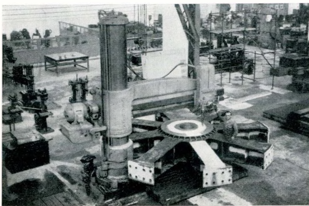
Fig. 32 - Costruzione della ruota polare.
