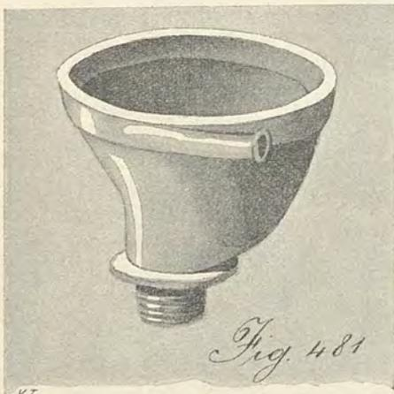
a chiusure idrauliche in ghisa smaltate internamente del tipo ad  $\infty$  ordinario, od anche di tipo speciale, si hanno dei vasi di maiolica a bocca superiore ovale, internamente foggiate in diversa maniera, a seconda anche dei diversi modi coi quali in essi avviene la lavatura, ma sempre in guisa da presentare nella parte inferiore una disposizione
