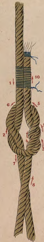
Fig. 6. - Il nodo della fune di sollevamento del maglio
