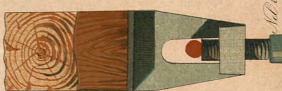
Fig. 11. Il fianco del particolare sul piede della saetta
