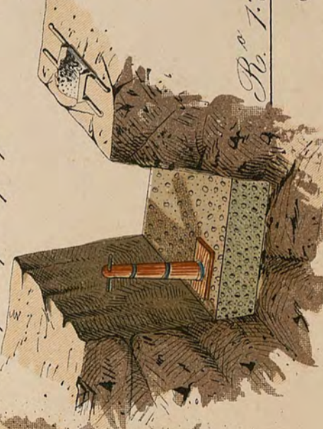
Fig. 6. - Una macchina a manovra per calare e posare il calcestruzzo nell'acqua.
