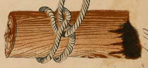
Il nodo del capo della fune inteso all'antenna
