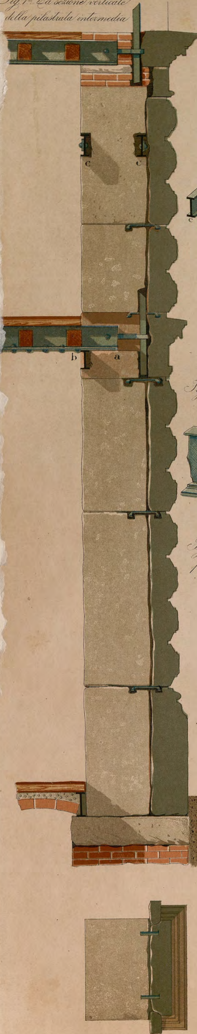
Fig. 5. - L'allacciamento dei travicelli c alla pilastrata
