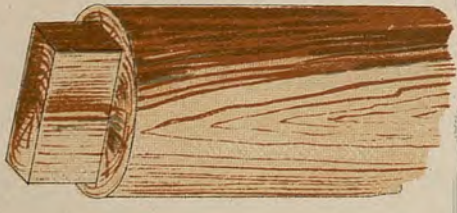
Fig. 2. Il dente per la coartatura del palo alla traversa
