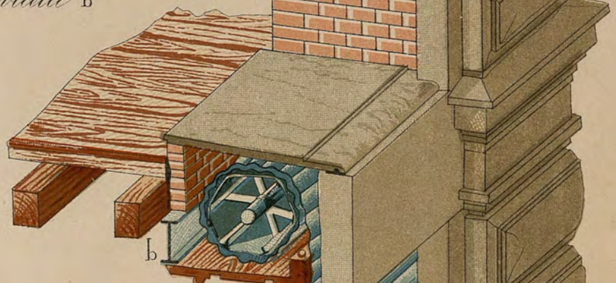
Fig. 8. Un particolare per l'appoggio dei travicelli di legno.
