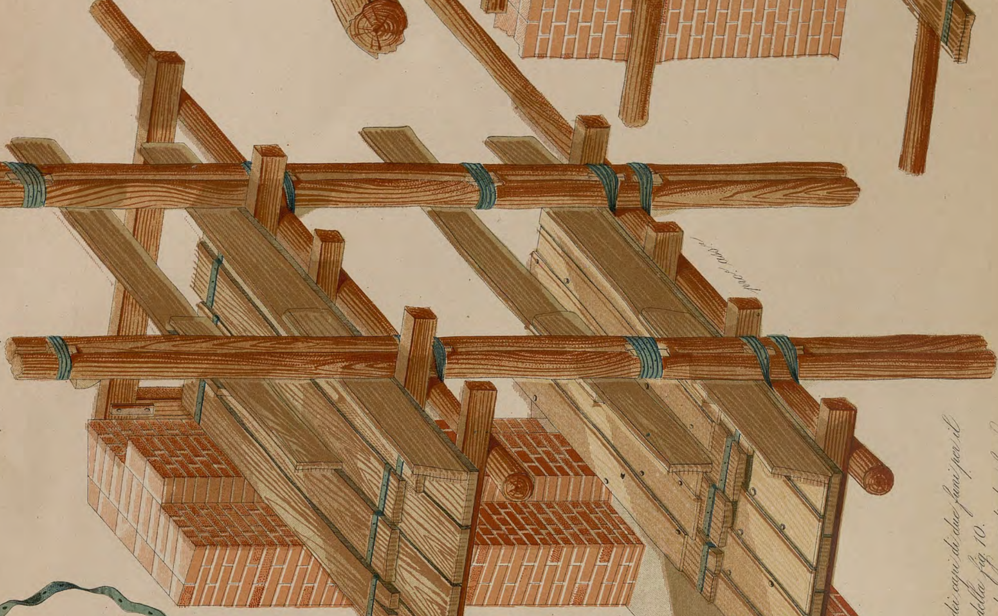
Fig. 4. - L'appoggio e la fasciatura delle pile
