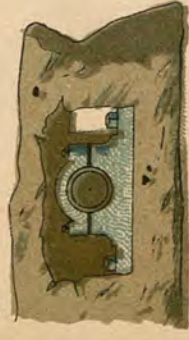
Fig. 6. L'incassatura nel punto per cuscinetta.
