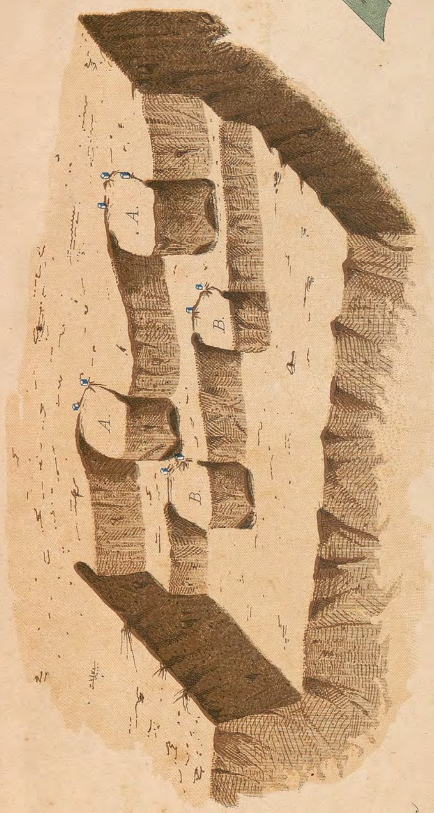
Fig. 10 - L'avanzamento dello scavo nelle terre compatte in genere
