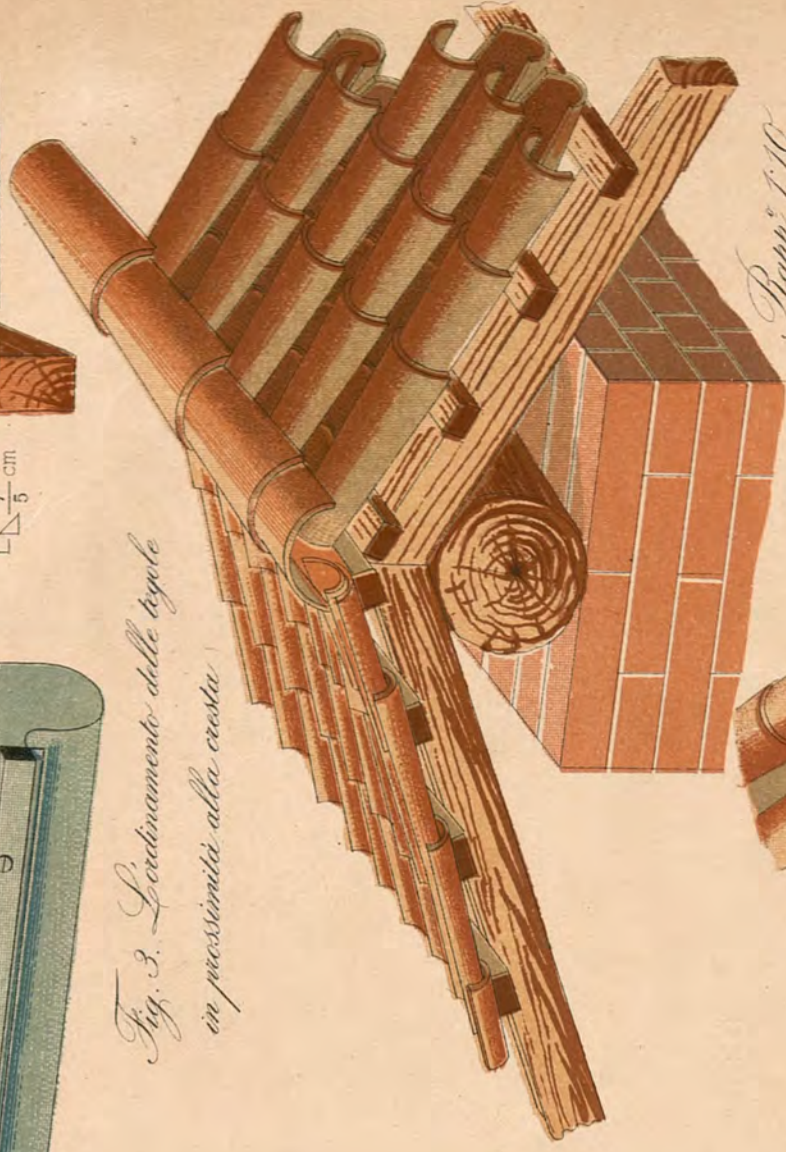
Fig. 4. L'ordinamento delle tegole per la formazione del disparte
