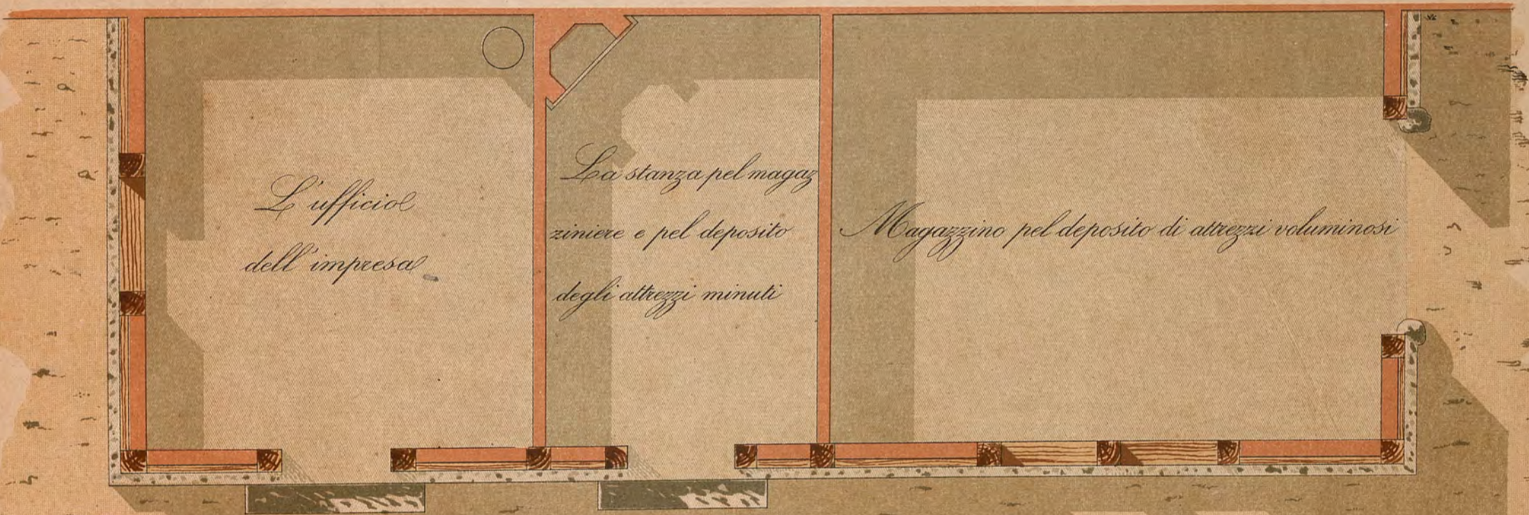
Fig. 1 La pianta della baracca per l'impresa
