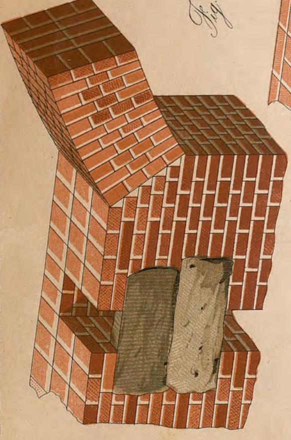
Fig. 4. Il particolare delle chiavi di pietra per l'incassatura di un condotto
