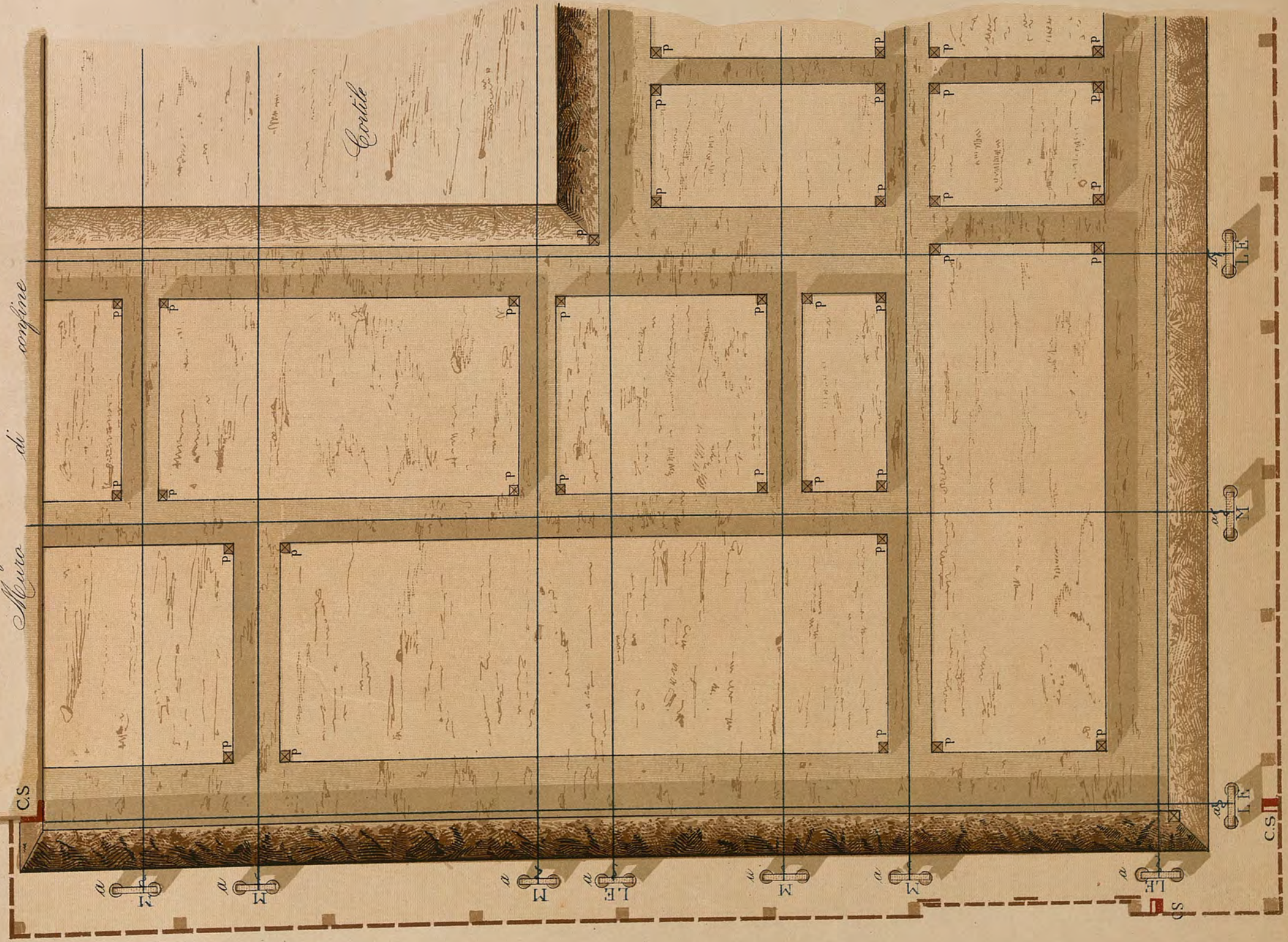
Fig. 2.-L'ordinamento dei cavalletti, fili e picchetti per l'incamminamento dei muri e per il tracciato delle fosse di fondazione riferito ai caposaldi
