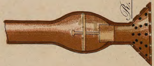
Fig. 8. La valvola al piede del tubo d'aspirazione
