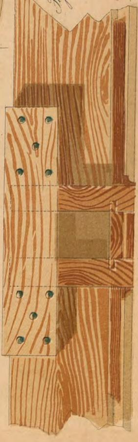
Fig. 4. La pianta per l'incastro della trave
