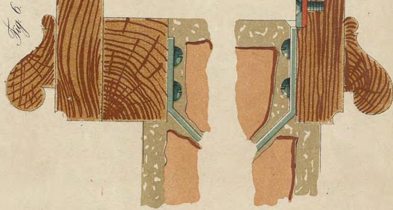
Fig. 5-6. Particolare in sezione orizzontale per l'applicazione dei ferri della fig. 2. e 4. agli stipiti ed ai battenti.
