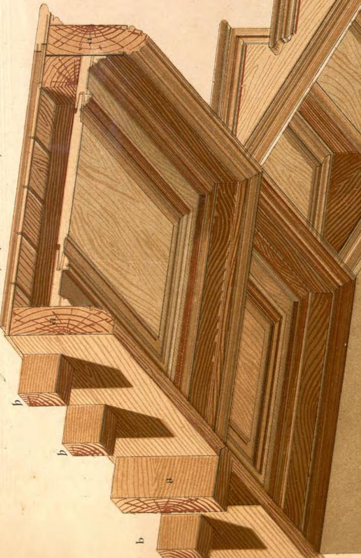
Fig. 1. La sezione verticale di porzione di una banca e del pianocattolico, ed il fianco di porzione dell'altra banca
