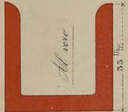
Fig. 5. La piastra di fero a ranca per fermare al muro il supporto dell'ingranaggio conico da piede della fig. 2.
