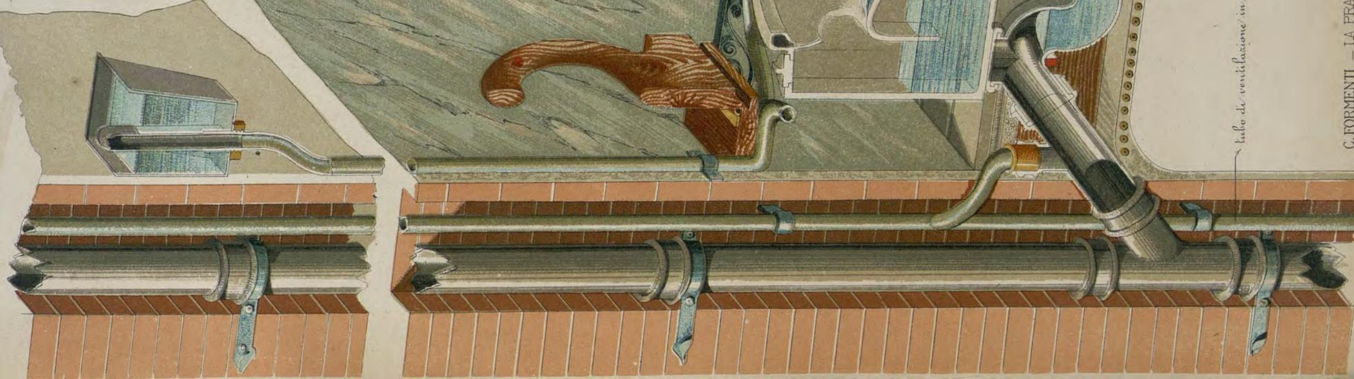
tubo di ventilazione in piombo diam. 25
