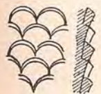
Fig. 177. — Disposizione di una parete riflettente i raggi sonori in direzioni volute.
