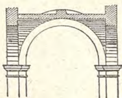
Fig. 1109. — Vólta a crociera con archi frontali semicircolari e unghie cilindriche.
