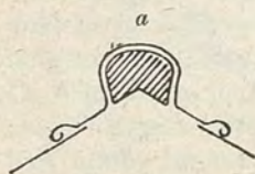
Fig. 1563 a , b . — Colmi con profilo speciale ricoperti con lamiera metallica.
