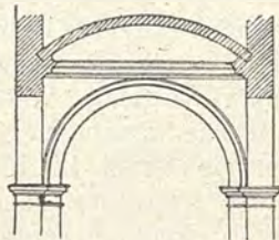
Fig. 1030. — Vólta a vela su pianta quadrata, con cornice alla base della calotta.
