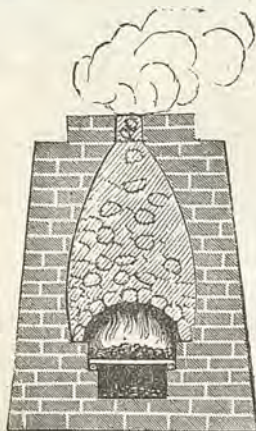
Fig. 509. — Forno da calce intermittente con graticola.
