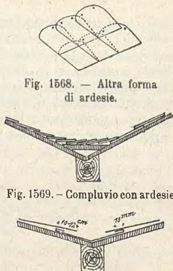
Fig. 1571. — Disposizione della lamiera di zinco in un compluio.
