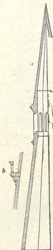
Fig. 1301-1302. — Guglia divisa in due parti: a , da un tamburo intermedio; b , da una loggetta sporgente all'ingiro.
