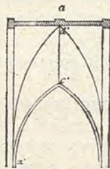
Fig. 1132 a, b. — Volta a crociera acuta con spazio rettangolare rettangolare.
