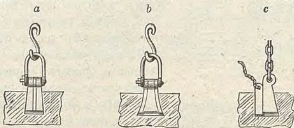
Fig. 565. — Ulivelle per il sollevamento di pietra da taglio.
