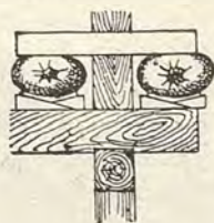
Fig. 1278. — Disarmo con sacchi di sabbia.
