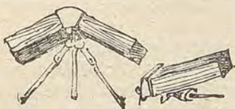
Fig 52. — Scatola e staffa di ferro per un'incavallatura mista Polonçeau.
