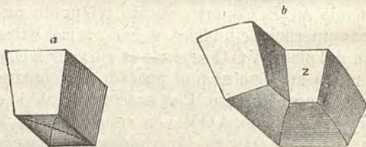
Fig. 1063 a, b. — Particolari dei conchi di chiave e degli spigoli di una vólta a padiglione.
