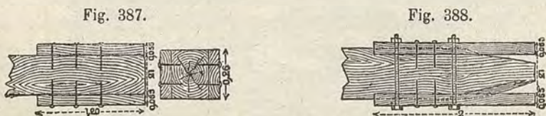
Fig. 387 e 388. — Rinforzamento di teste di travi.
