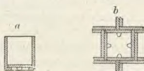
Fig. 1248 a, b. — Celle della vólta della Pinacoteca di Monaco.
