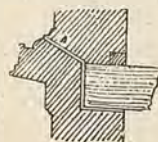
Fig. 98. — Testa di trave circondata da uno strato d'aria rinnovabile.
