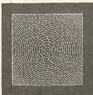
Fig. 1035. — Apparecchio anulare per vòlte a vela.
