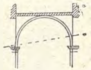
Fig. 1122. — Sez. di volta a crociera su spazio curvo, colla linea del vertice orizzontale.
