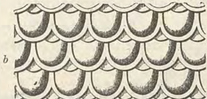
Fig. 2174 a, b, c. — Forme diverse di tegole di zinco stampate a squama.
