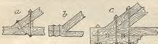
Fig. 50. — Unioni rinforzate da chiavarde fra le cater e i puntone di capriate.
