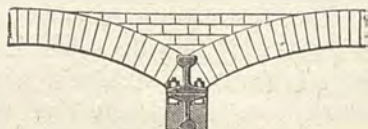
Fig. 975. — Voltine su rotaie accoppiate.
