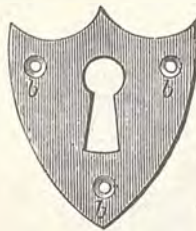
Fig. 583. — Scudetto semplice da serratura.
