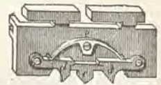
Fig. 562. — Stanghetta a doppia mandata con congegno di sicur. per evitare la rottura delle barbe della chiave.
