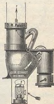
Fig. 1185. Riscaldamento del sifone per impedire congelamenti.
