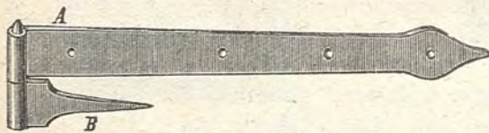
Fig. 322. — Ganghero da sfilare. A, bandella diritta; B, bandella a punta.
