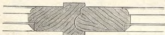
Fig. 180. — Modificazioni alla battuta a gola di lupo per impedire le correnti d'aria.
