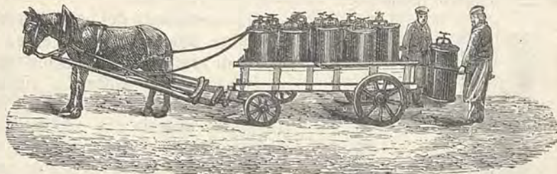
Fig. 1192. — Carro semplice ad un cavallo per trasposto di dieci fosse mobili.
