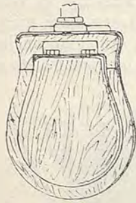
Fig. 1153. Assicella con coperchio per vaso da cesso.
