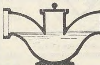
Fig. 1127. — Sifone con foro di ispezione.
