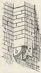
Fig. 1107. — Latrina di un castello medioevale. a, sedile; b, mensole; d, porta.
