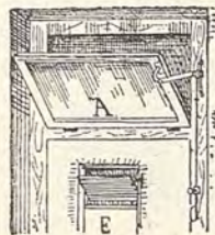
Fig. 501. — Congegno Spengler per ribalte semplici e senza serratura.
