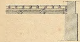
Fig. 58 - Appoggio della trave (1:20)
