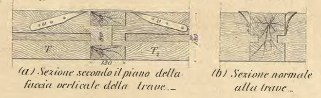
Fig. 67 - Incastro della trave alla traversa (1:10)
