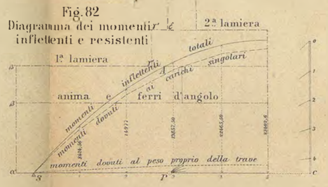
Scala delle forze 1 mm = 200 Kg. - dei momenti 1 mm = 500 Kgm.
