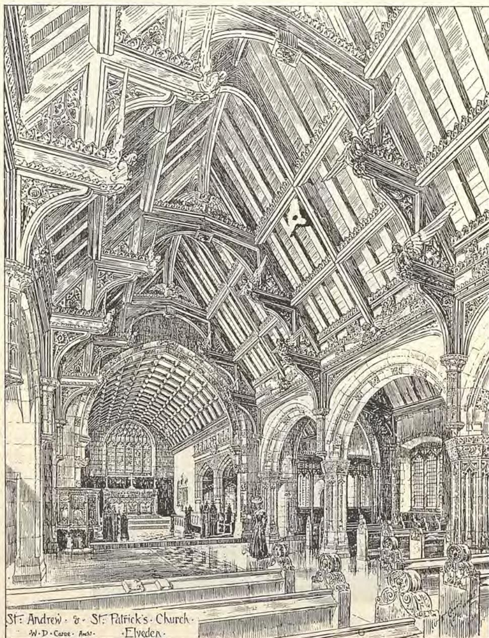
Fig. 659. — Soffittatura di una navata di chiesa, di tipo inglese.
