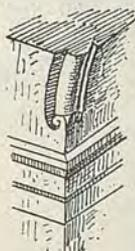
Fig. 611. — Smussatura dello spigolo di un archivolto.
