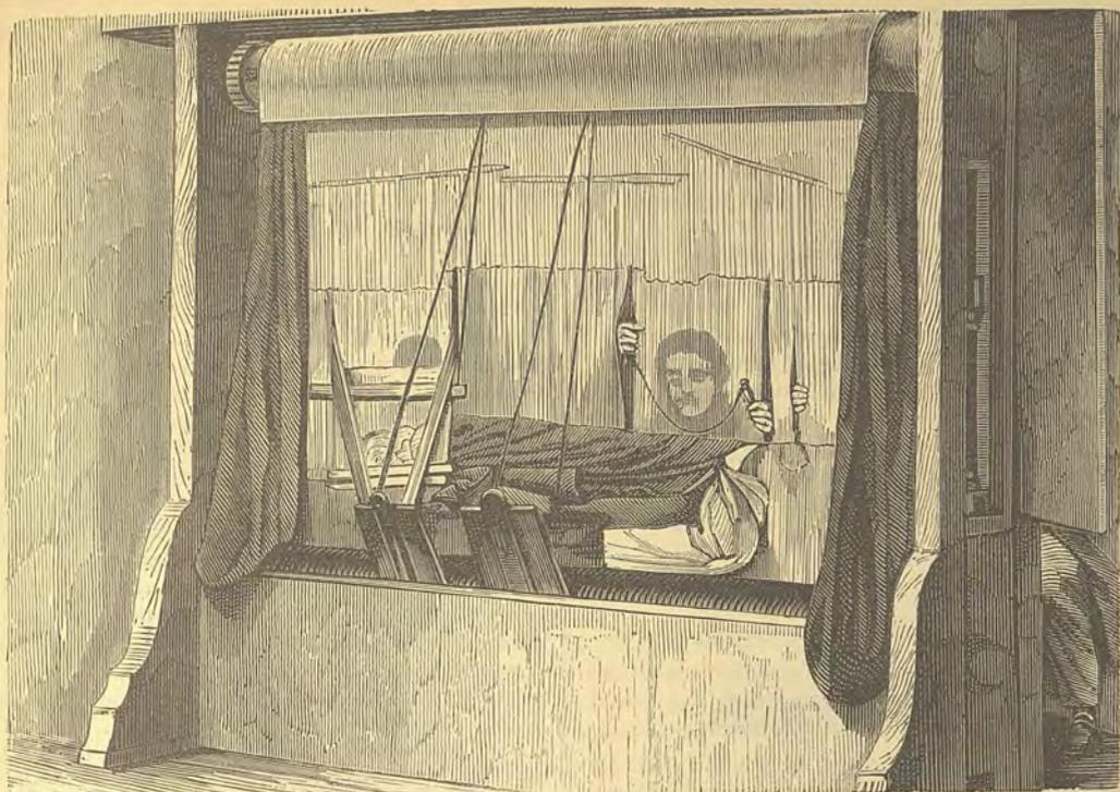
Fig. 139. — Telaio ad alto liccio.
