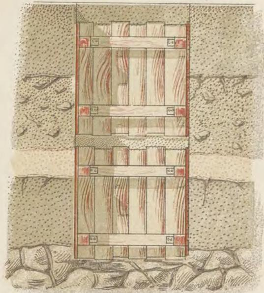
FIG. 5 *L'armatura in terreni consistenti*
