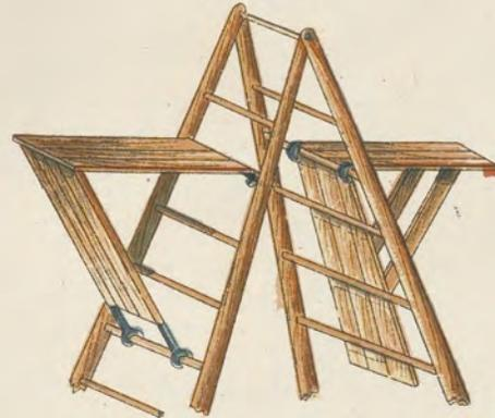
FIG. 4 *I ponticelli a sbalzo raccomandati ad una scala a pioli*
