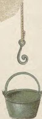
FIG. 4 *Il secchio di ferro per le calcine*
