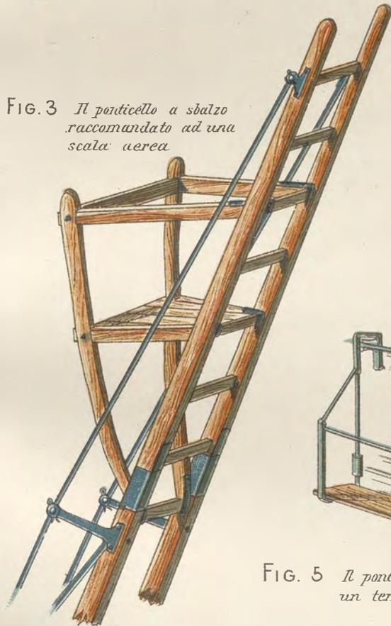
FIG. 3 *Il ponticello a sbalzo raccomandato ad una scala aerea*
