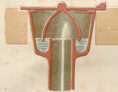
FIG.6 Il tipo di chiusura a campana
