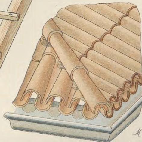
FIG.3 Il dispiuvio nella copertura di tegole a canale.
