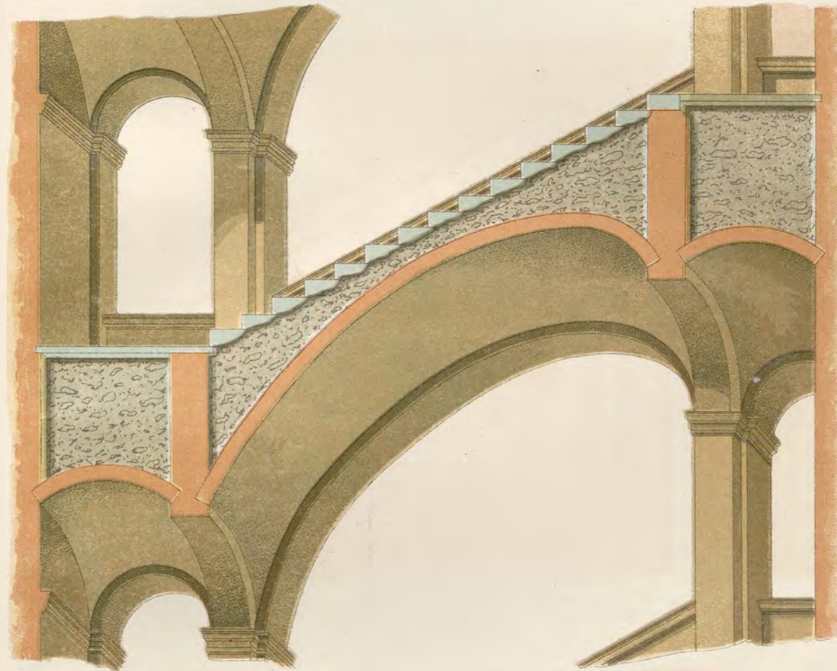
FIG. 3 La branca sostenuta da volta veloidica rampante
