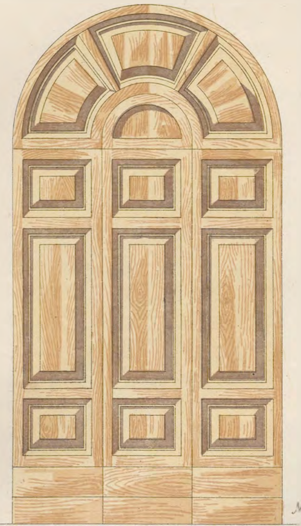
FIG.8 L'imposta a 3 battenti con doppio tavolato o costruita con specchiature incastrate
