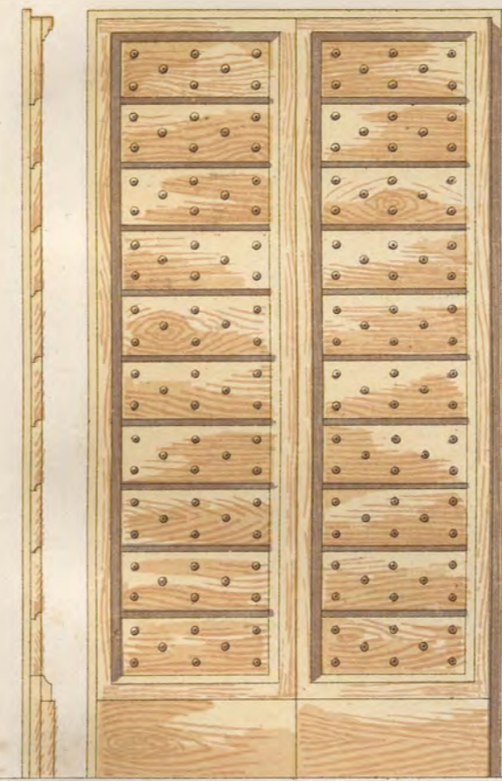
FIG.7 L'imposta a due battenti con fodera bugnata e guarnizione di tavola
