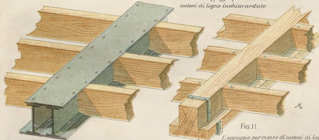
FIG. 10. La trave maestra tubolare
