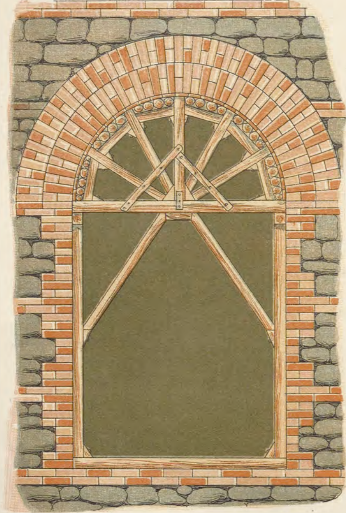
FIG. 1 La centina di travi radiali
