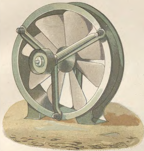
FIG. 1 Il ventilatore Schiele ad elica tipo verticale
