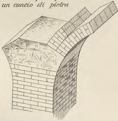
FIG. 5 L'imposte di una piattabanda per un passaggio
