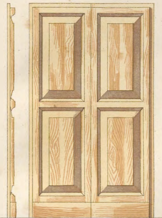
FIG.5 L'imposta a due battenti con fodera a specchiature
