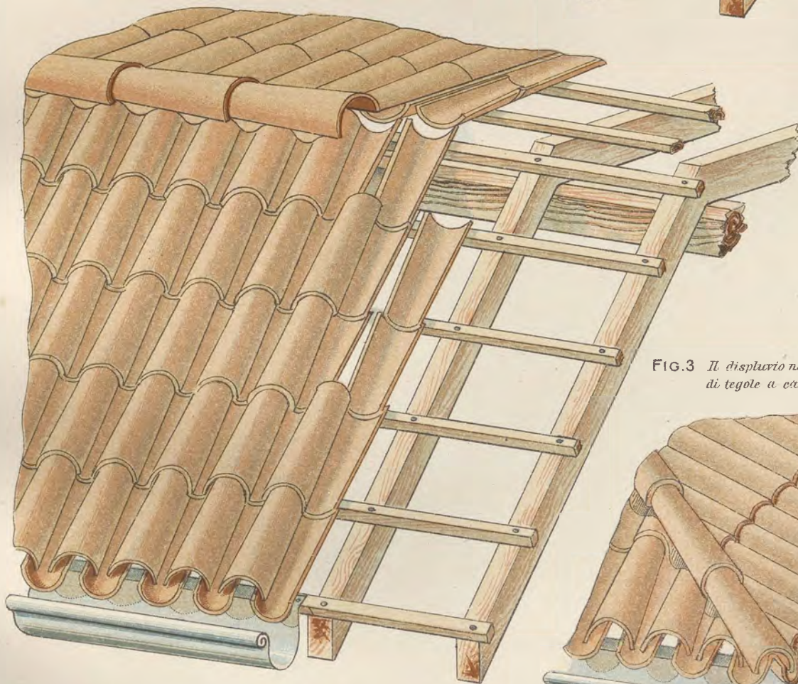
FIG.2 La copertura di tegole a canale
