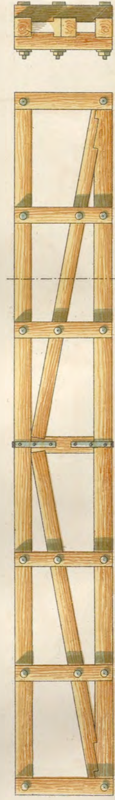
FIG. 4. Altro tipo di trave composta con puntoni
