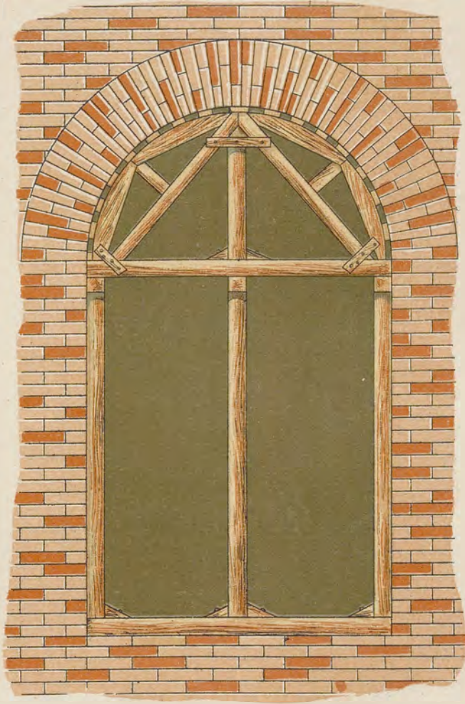
FIG. 9 La centina con elementi triangolari per un arco a tutto sesto
