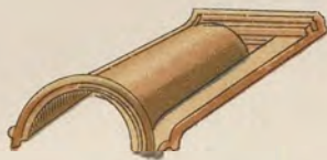
FIG.3 Una forma di sfiatatoio.
