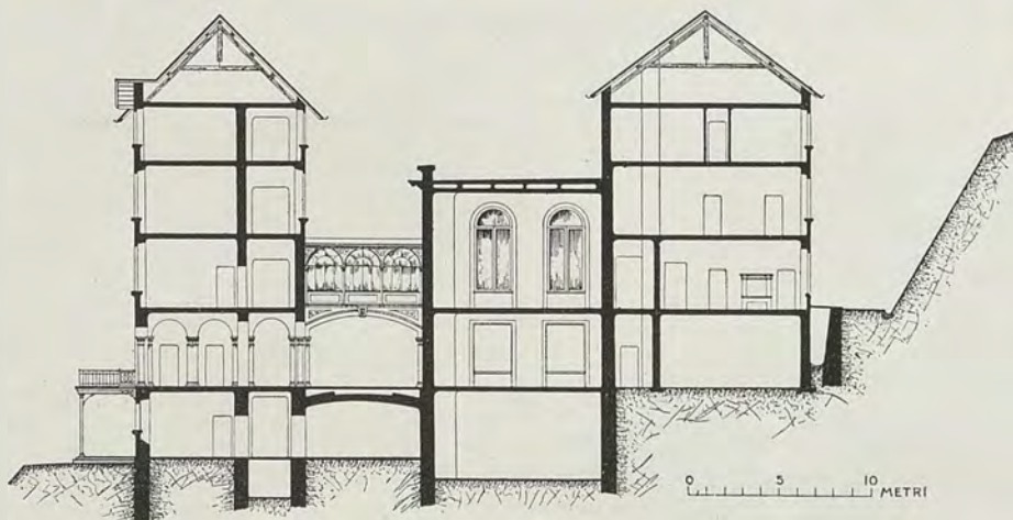
Sezione trasversale dell'edificio principale.
