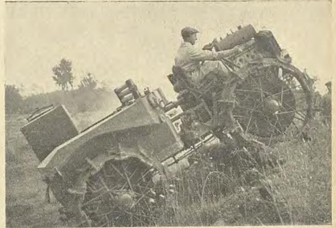
Fig. 4. - Trattore Pavesi-Fiat con gazogeno Nostrum. Capacità di traino: 12 tonnellate. - Consumo: Kg. 0,650-0,700 di carbone per Km. - Autonomia: Km. 100.
