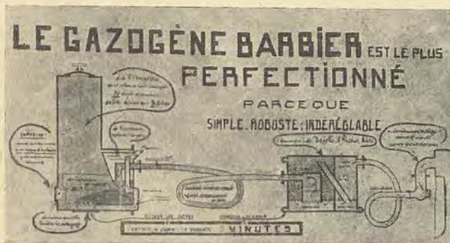
Fig. 3. - Schema di gazogeno a tiraggio orizzontale.
