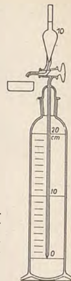
Fig. 2 — Sedimentatore di Andreasen. (Nel cilindro viene introdotta una miscela di cemento in alcool, contenente circa 1 % di cemento in volume).
