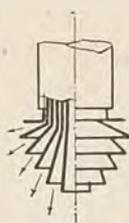
Fig. 16 - Dispositivo di introduzione a diffusione.
