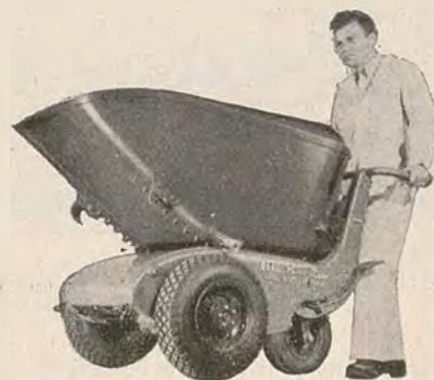
Fig. 10. — Carriola automotrice con benna rovesciabile.
