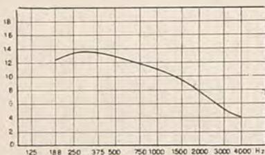
Fig. 3 (in alto) — Tempo di riverberazione della camera riverberante in funzione della frequenza.
