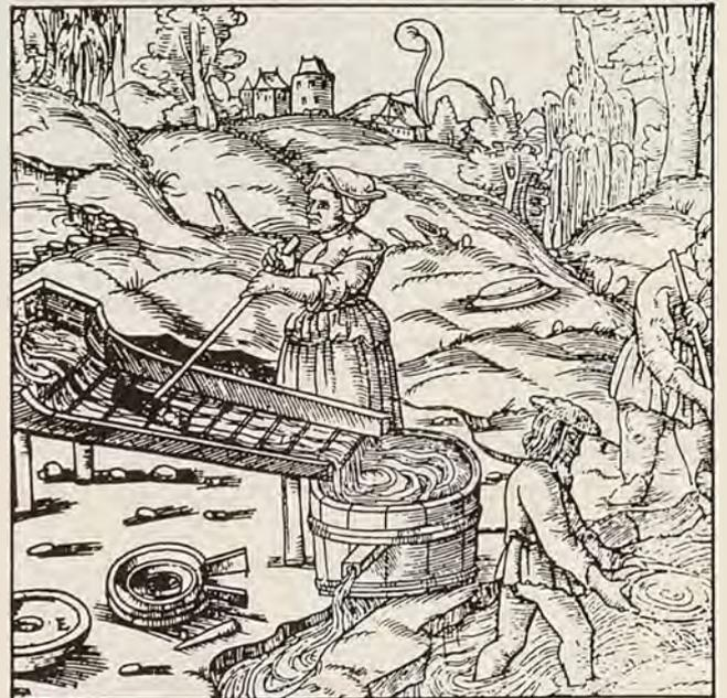
Fig. 4 - Tecnica medioevale di lavaggio a mezzo di un canale con risalti. Tale tecnica è tuttora la più usata. (Da Agricola).
