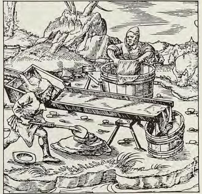
Fig. 3 - Tecnica medioevale di lavaggio a mezzo di un panno. (Da Agricola).
