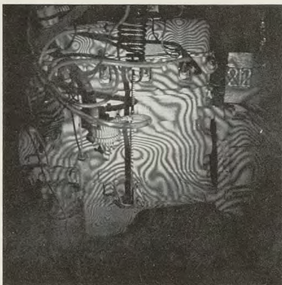
Comportamento dinamico delle strutture di un motore durante il normale funzionamento ricavata a mezzo di tecniche olografiche con laser a doppio impulso.
