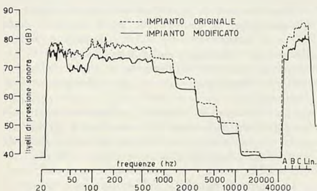
Fig. 9 - CABINA DI VERNICIATURA - IMPIANTO IMMISSIONE ARIA - Analisi frequenzimetrica del rumore in Near Field.
