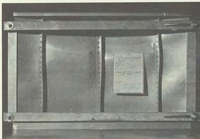
Fig. 4 - Pannello con incastro in zoccolo e resina (tipo B).
