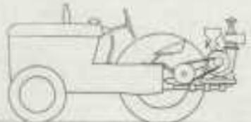
Fig. 3. - Schema di trattore con pompa centrifuga portata.
