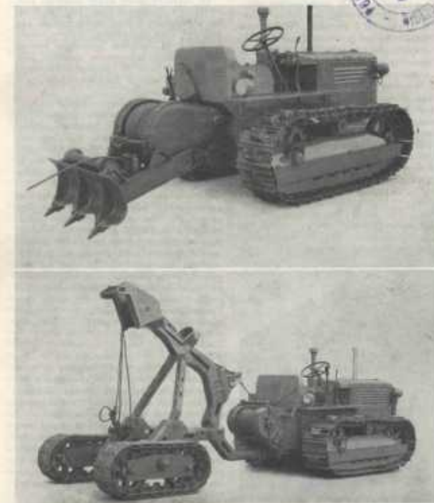
Fig. 10. - Carrello portatronchi Schmidtlwerke e verricello FIAT VS-2 su trattice FIAT 55L.
