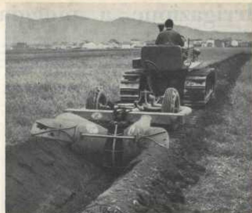
Fig. 11. - Carrello universale tornando idraulico SIMA con attrezzo affossatore trainato da trattrice FIAT 55L.
