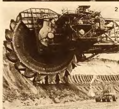
1. Scuola tecnologica all'Esposizione di New York, 1964. 2. Escavatore con ruota a pala in una cava di lignite tedesca. 3. M. Pitt, T. Mc
