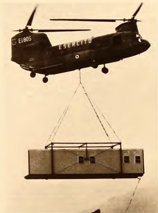
Un elicottero birotore EMB CH-47C Chinook dell'Esercito Italiano nel corso di operazioni di protezione civile in Irpinia, in occasione del terremoto. Il Chinook può agevolmente sollevare carichi del peso di oltre 9 tonnellate, trasportare 44 militari con equipaggiamenti di soccorso, oppure una unità ospedaliera ESFC.
