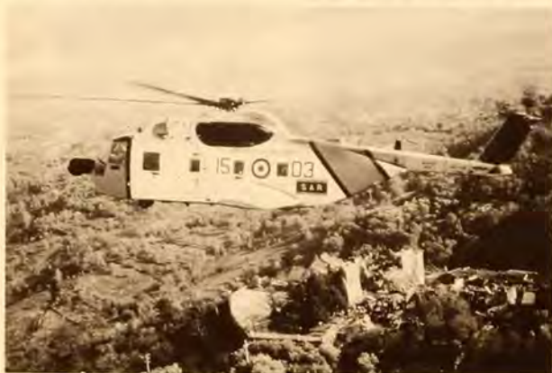
L'HH-3F, realizzato per assolvere missioni di ricerca e salvataggio, possiede un'autonomia di volo di oltre sette ore ed è in grado di perlustrare 21.000 miglia quadrate nel corso di una sola missione senza rifornimento.
