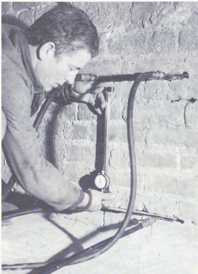
Fig. 2 - Prova con due martinetti piatti (40×20 cm) per la misura del modulo di deformabilità.
