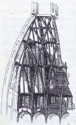
Fig. 3-4 - Lo scheletro del volto della Mole Antonelliana realizzato con un sistema di archi incrociati che richiama quelli adottati dal Guarini nella Chiesa di San Lorenzo in Torino.
