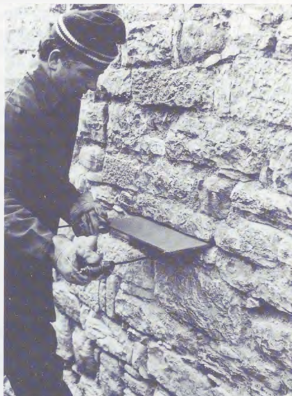
Fig. 11 - Prova con martinetto piatto sulla muratura in pietra della Chiesa della Madonna del Prato di Gubbio.
