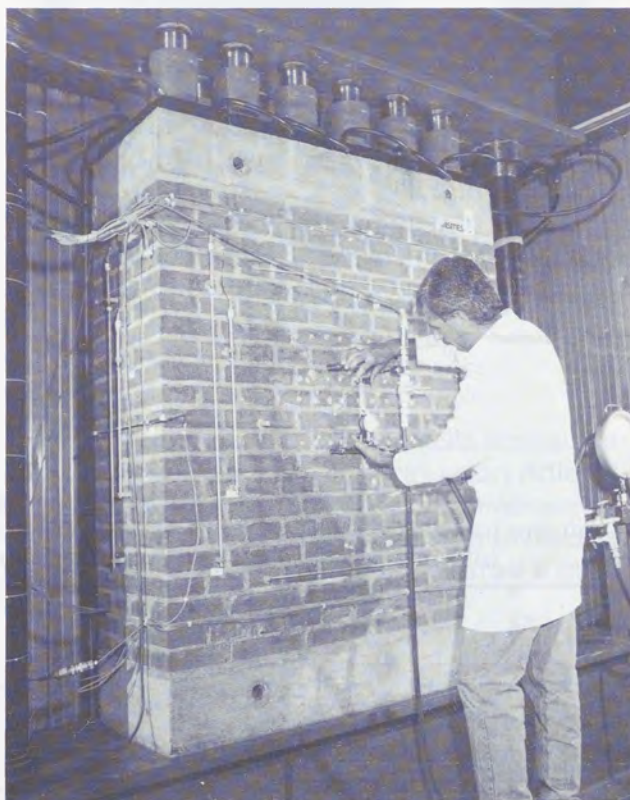
Fig. 5 - Taratura della prova con due martinetti piatti per la determinazione del modulo di deformabilità.
