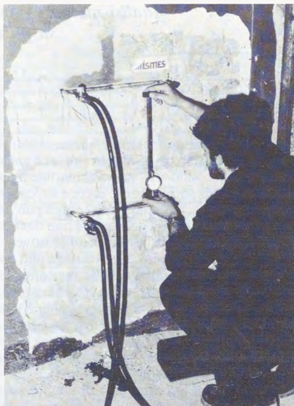
Fig. 13 - Collegio Massimo - Roma. Prova di deformabilità su una parete composta da mattoni e blocchi di tufo.
