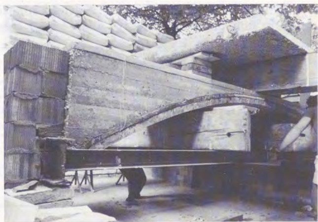
Fig. 7 - La volta della figura precedente in fase di scarico. Si osservi la assoluta assenza di lesioni nella volta in mattoni e la perfetta aderenza nell'interfaccia mattone-vetroresina.
