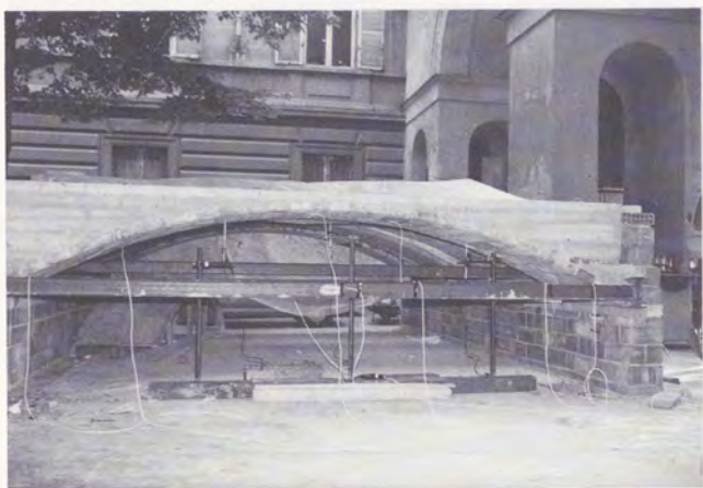
Fig. 4 - Predisposizione dei modelli nella scala reale delle volte di cui alla fig. 3, per le prove sperimentali su diversi sistemi di consolidamento (Studio Fois - de Cristofaro; realizzazione SIRCE di Parma).
