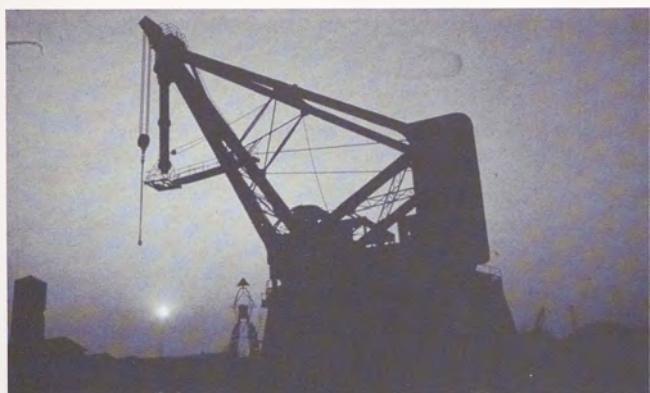
Fig. 10 - La grande gru idraulica da 160t dell'Arsenale di Venezia, costruita dalla Armstrong e Mitchell & C. di Newcastle negli anni 1883-1885.
