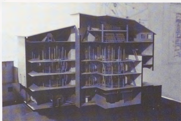
Fig. 1 - a) Disegno del modello funzionante di filatoio-torcitoio da seta rotondo costruito dal Museo Aldini-Valerani di Bologna per la XVII Triennale di Milano (da: R. Curti, in Il luogo del lavoro , cit., 1986, p. 59).
