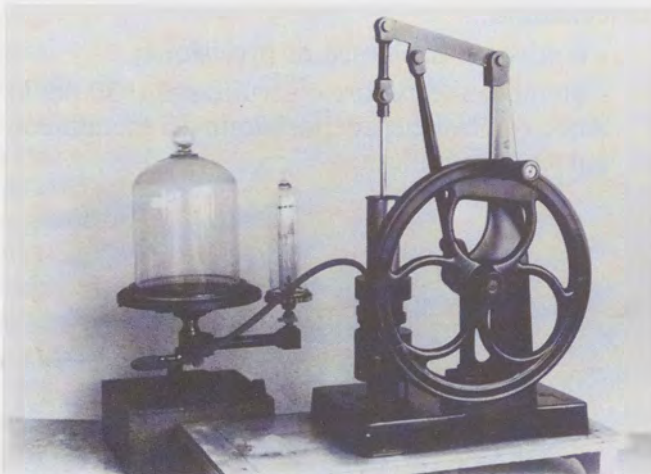
Fig. 4 - Pompa a stantuffo per creare il vuoto (1920).
