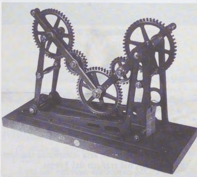
Fig. 6 - Trasmissione con ruote dentate tra assi paralleli a distanza variabile (modello in acciaio).
