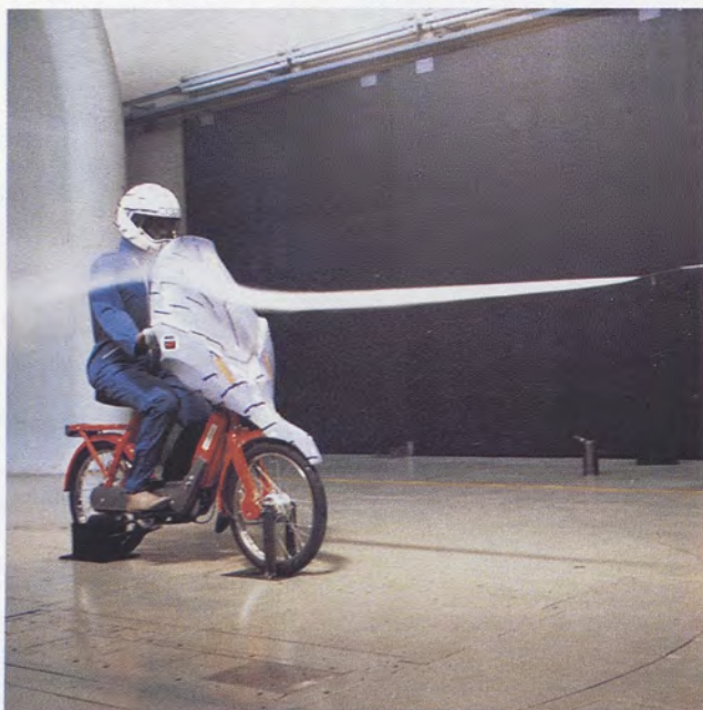
GIARDINO DESIGN: schermo protettivo per ciclomotore, prove in galleria del vento, prototipo, 1985
