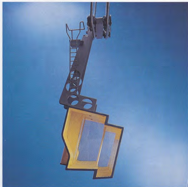
V. PREGNO, P. SANTI, G. TRABIA: cabina funivia in alveolare di alluminio, Corso di D.I., prof. G. De Ferrari, a.a. '86-'87
