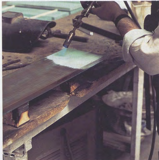
Processo di ossidazione di particolare in rame
