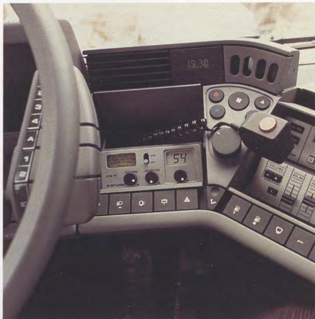
G. STUDIO: modello in polistirolo di interno vettura, scala 1:1, 1990
