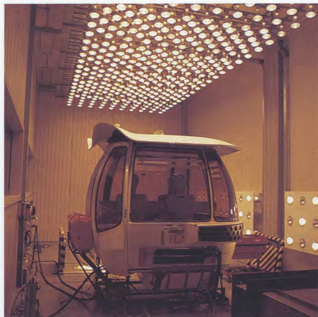
GIARDINO DESIGN: telecabina per EXPO SIVIGLIA '92, prove in camera termica, prod. LEITNER, 1991
