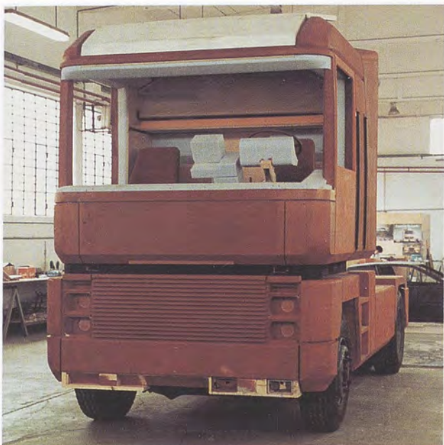
Modello in fase di costruzione, scala 1:1
