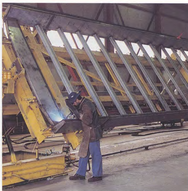
Fase dell'assemblaggio di un carro per trasporto auto dell'ultima generazione
