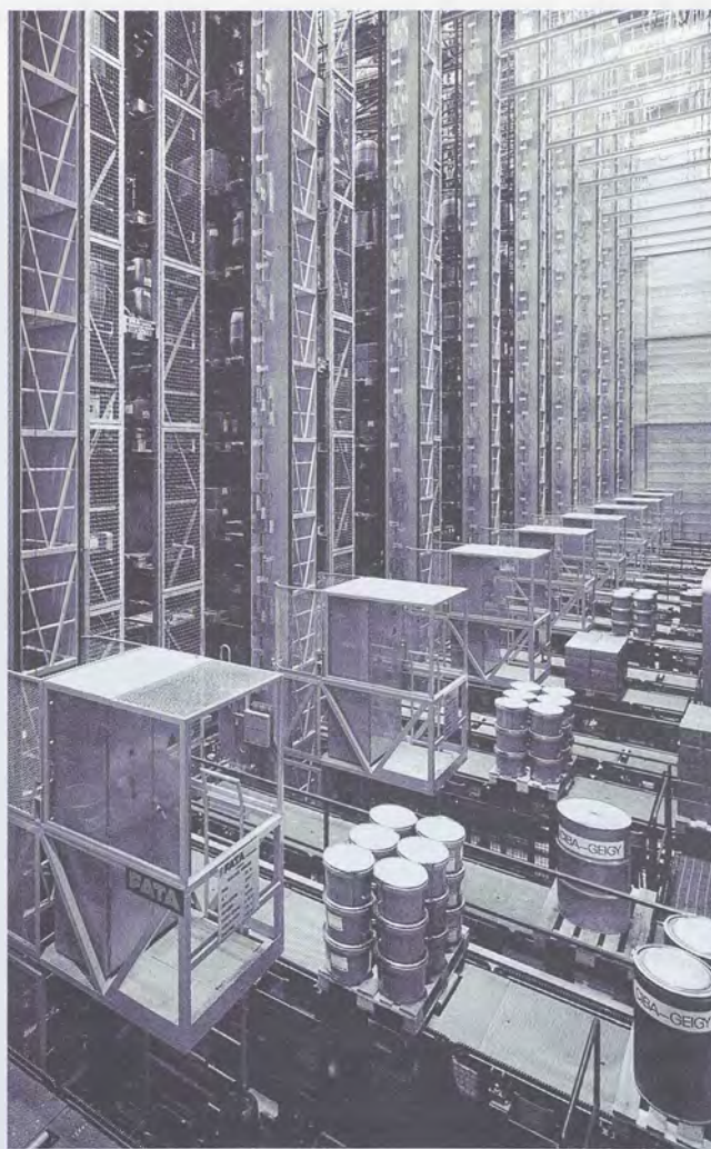
Fig. 1 - Magazzino automatico a più corsie con trasloelevatori e trasportatori di testata.
