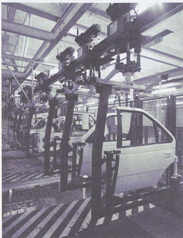
Fig. 3 - Trasportatore ad automotore - zona di accumulo.
