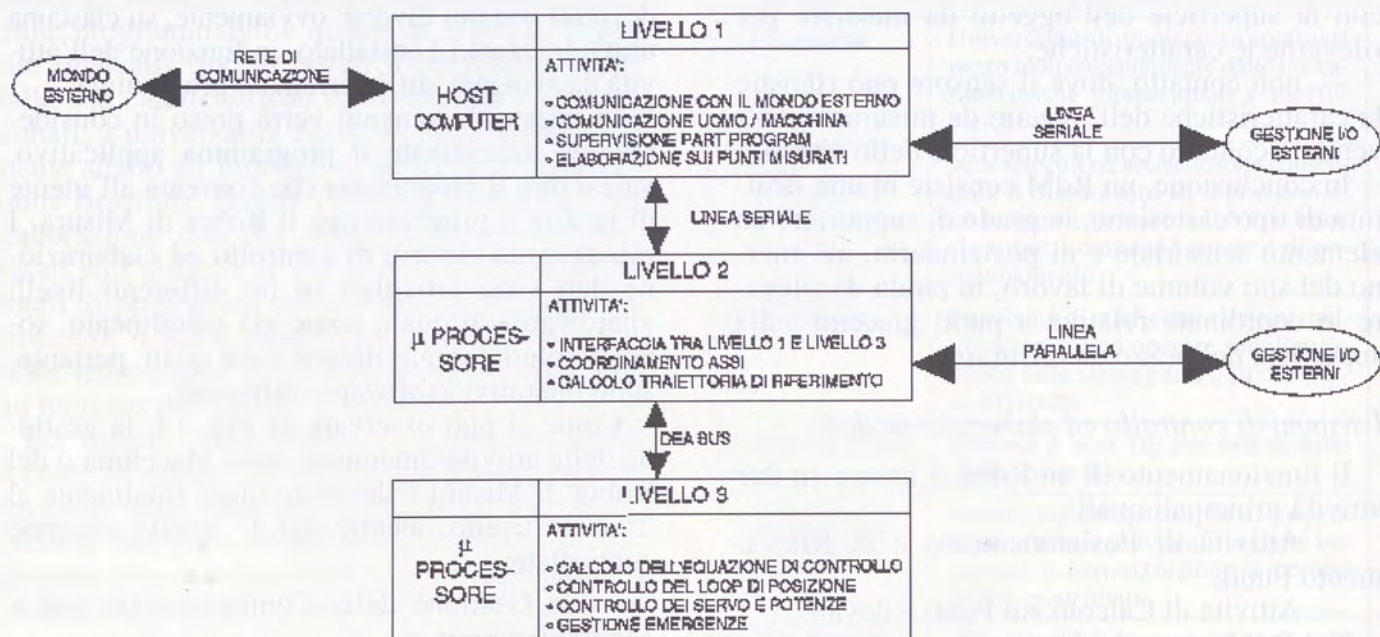
Fig. 13 - Struttura di un sistema di controllo ed elaborazione dati Dea «Master F2».
