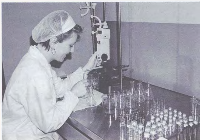
Fig. 6 - Laboratorio: un momento dell'analisi sulle caratteristiche chimiche del vetro, riguardanti le cessioni idrolitiche.
