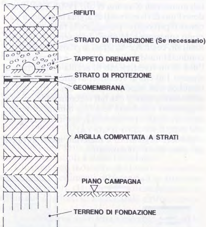
Fig. 6 - Rivestimento di base (ETC8).
