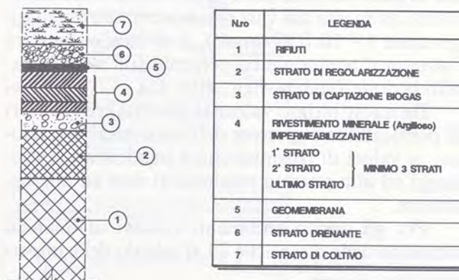
Fig. 38 - Stratigrafia della copertura di una discarica come consigliato da ETC8 (1991).
