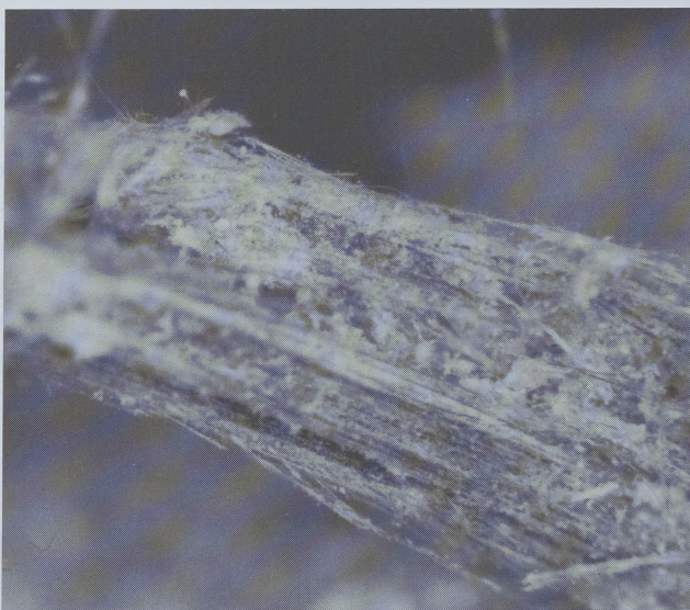
Fig. 1 - Frammento di fascio di crocidolite che fuoriesce dal bordo della lastra in cemento-amianto.
