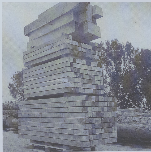
Fig. 13b - Bonelli, Costruzioni in legno - Savigliano. Catasta di PLS, materiale innovativo, resistente all'acqua, al carico, con buona compattezza di fronte ai chiodi, per la realizzazione di pallet (da Bonelli - Savigliano, Nuovo PLS ).
