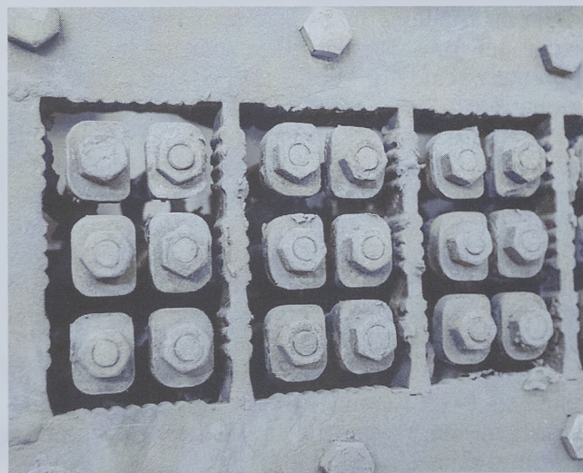
Fig. 2 - Dettaglio della filiera: il profilo in negativo di tre mattoni a sei fori.
