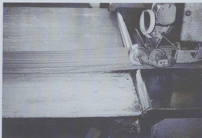
Fig. 12 - Dazeglio (TO), Compensati Toro. A sinistra, fase di lavorazione per la nobilitazione dei pannelli con lo stoccaggio degli sfogliati; a destra, particolare della cucitrice dello sfogliato per la nobilitazione dei pannelli truciolari (foto C. Bertolini Cestari, 1998).
