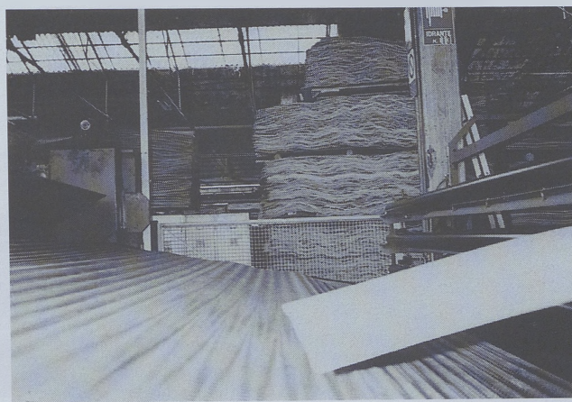
Fig. 11 - Dazeglio (TO), Compensati Toro. A sinistra, macchinari per la sfogliatura da legname tondo; a destra, macchina per la cucitura degli sfogliati (foto C. Bertolini Cestari, 1998).
