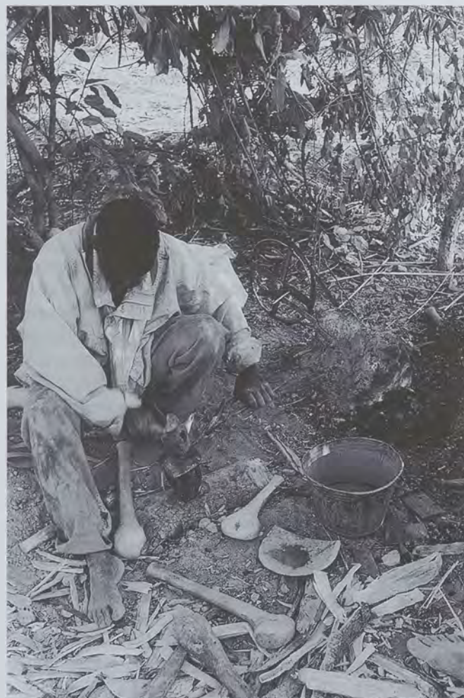
Fig. 3 - Operazioni di riforgiatura dei semplici e rudimentali strumenti di lavoro impiegati per lo scavo manuale di gallerie e pozzi in una miniera artigianale in Mali (1997). Queste tecnologie rudimentali e primitive erano in uso in Europa sino alla prima metà del '600 circa.
