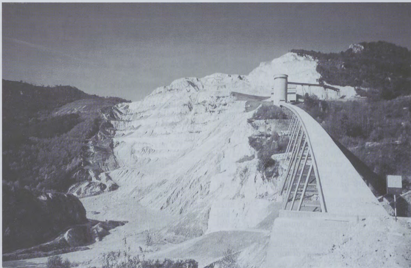
Fig. 1 - Cava Snive (Soc. SIRO). L'entrata in galleria del nastro trasportatore principale, che collega l'impianto di frantumazione a quota 1238, visibile in secondo piano, con gli impianti di trattamento a valle.
