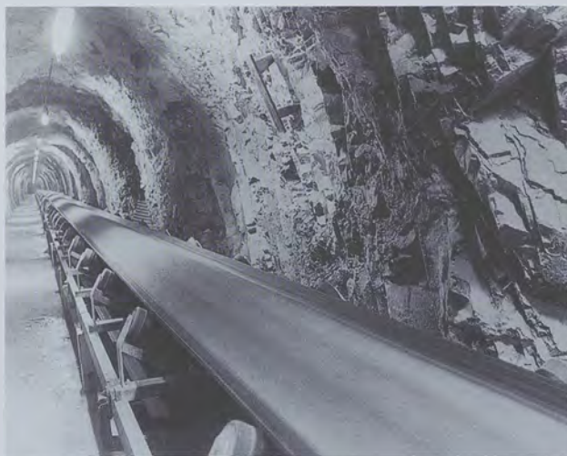
Fig. 2 - Nastro in galleria anni '80 (lung. 6000 mt, 1500 ton/ora).
