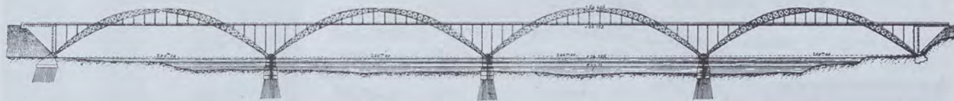
Fig. 3 - Progetto di ponte sul Danubio a Czernavoda, presentato dalla Union Dortmund (MM. Holzmann e Comp.ie). Anno 1884. Sono evidenti le cerniere di appoggio e di giunzione mutua.
