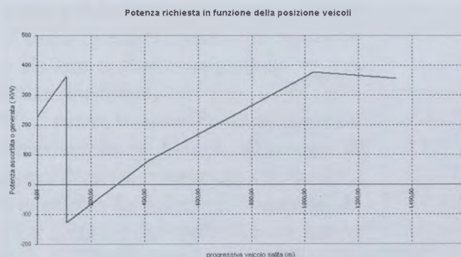
Figura 7. Rappresentazione grafica della potenza richiesta in funzione della posizione dei veicoli lungo la linea: esempio.
