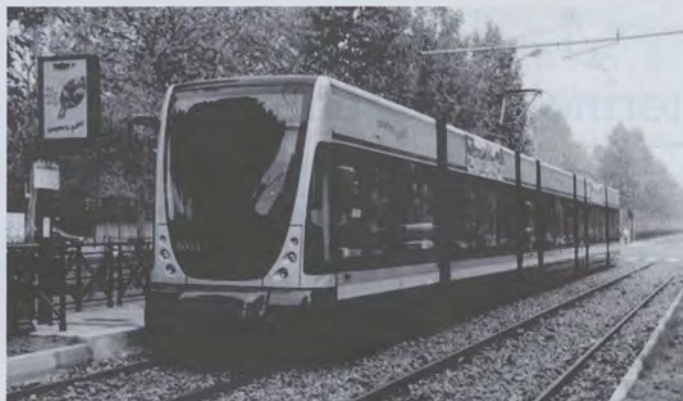
Esempio di veicolo della linea tranviaria 4 di Torino, denominato "Cityway", a pianale interamente ribassato.
