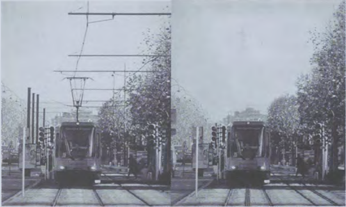
Eliminazione della catenaria grazie al sistema APS.
