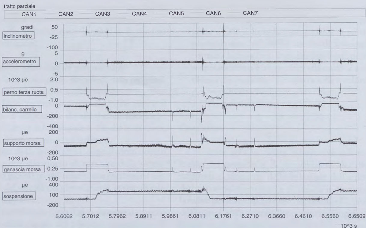
Grafico 2. Estratti dei grafici forniti dai punti di misura su una cabinovia, nell'arco un giro completo (espanso dal precedente).
