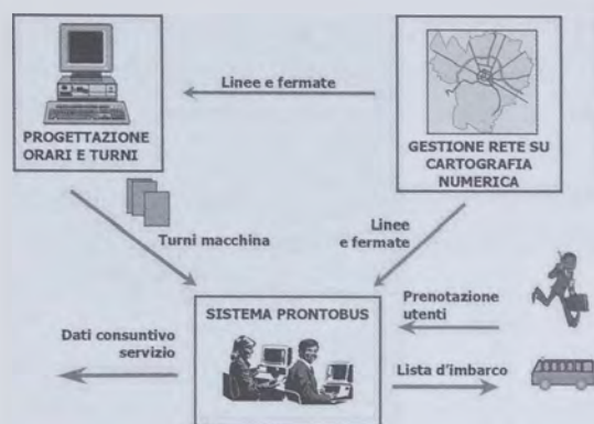
Figura 3. Architettura del software Prontobus.
