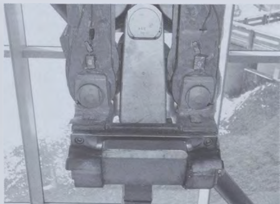
Estensimetri sul supporto della morsa (sopra i perni). Estensimetri sulla ganascia della morsa (sotto i perni).
