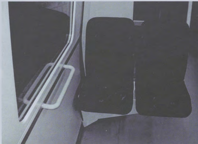
Interno del treno metropolitano C20 FICAS: parete laterale della cassa estremamente sottile compresa tra i 34 ed i 40 mm.
