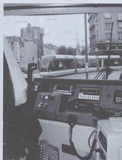
Cabina di guida identica ad un bus o filobus tradizionale: non è necessario istruire il personale conducente come per il tram.
