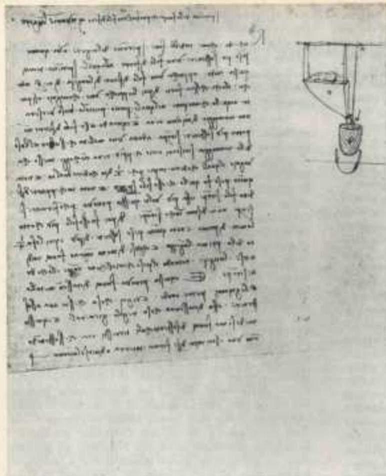
Fig. 1. - Prova alla trazione di un filo.
